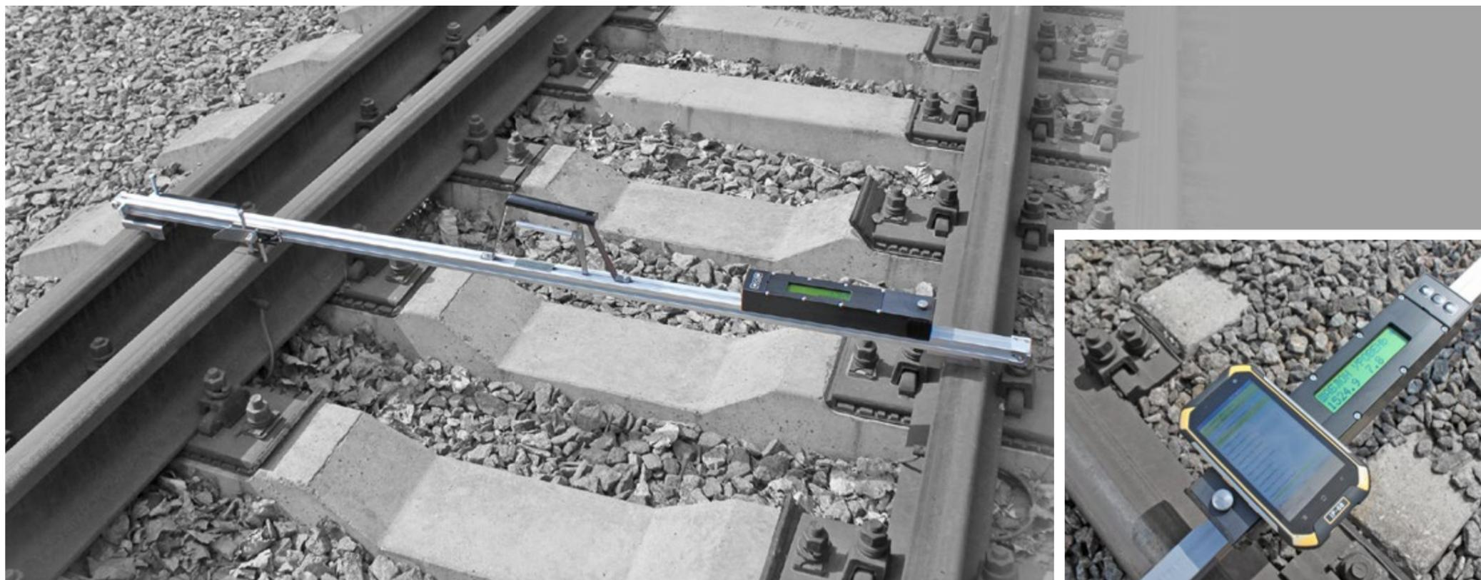
При необходимости передачи результатов измерений на удаленный компьютер, ШЭП может быть дополнен мобильным устройством — смартфоном МРМ (мобильным рабочим местом).
