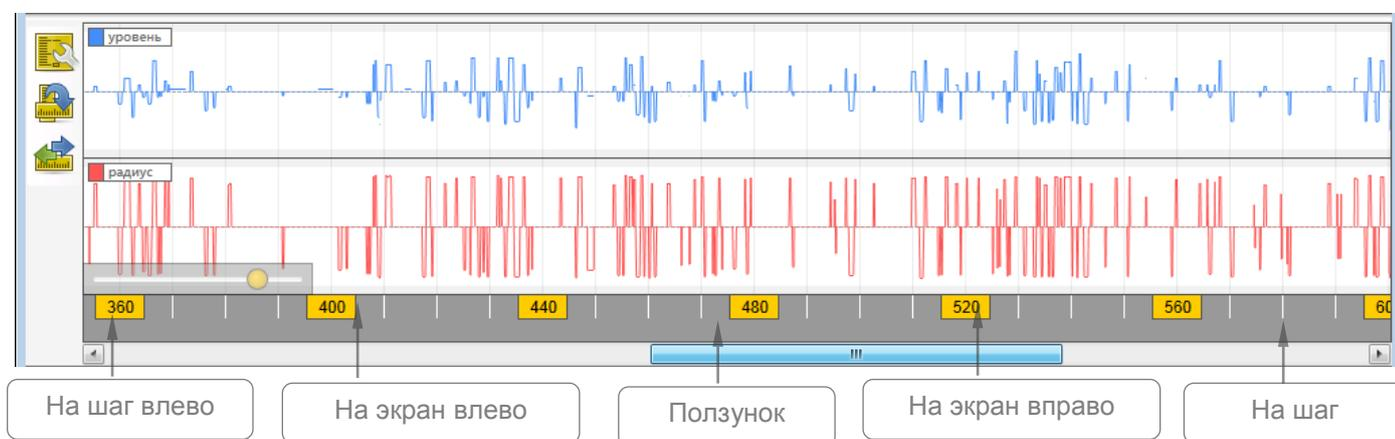
Рисунок 56 – Путеизмерительная лента. Полоса прокрутки
